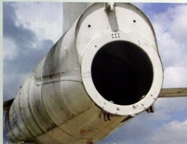
Die TM-61C unterschied sich von der TM-61A äußerlich durch einen Aufbau über der Düsenaustrittsöffnung, der von den Amerikanern „doghouse“ (Hundehütte) genannt wurde. Hier war das SHANICLE-Radarsystem untergebracht.
